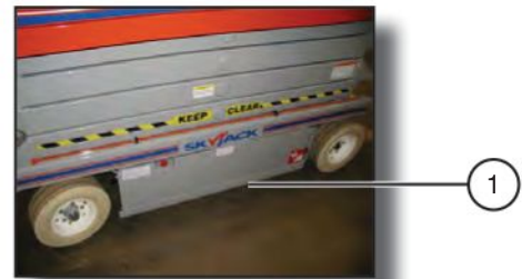
Figure 3-4. Dispositif de protection contre les trous
